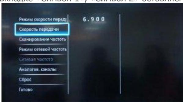
8. Теперь установите ручной режим сетевой частоты и с пульта управления введете сетевую частоту. Частота 306.00. Скорость передачи данных 6900кб/с. QAM64.
